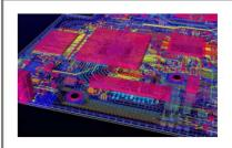
熱計算ツールを活用して導き出された内容を基に物理的なアプローチ(導体厚変更や層構成提案など)と、電気的なアプローチ(最適なODT提案を含めたSIシミュレーションなど)を組み合わせた提案を実施。最適なパターン設計を行う。
